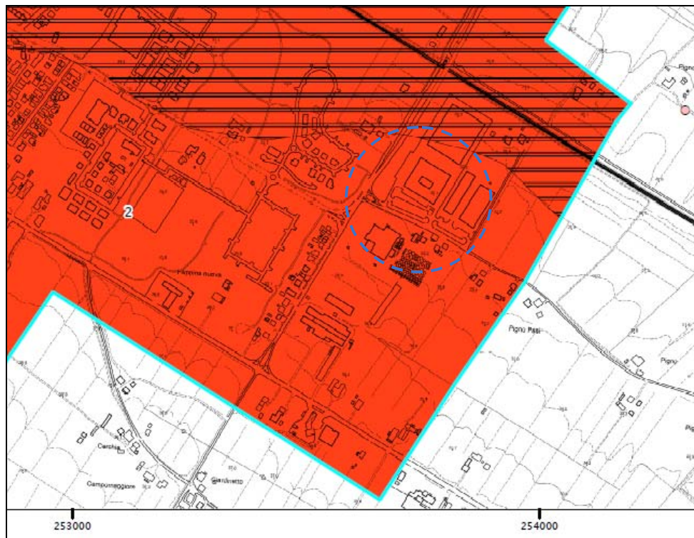
Fig. 3: Carta di microzonazione sismica di livello 3 – FH 0,1-0,5s
